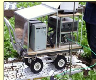
可搬型蛍光レーザー分析装置
