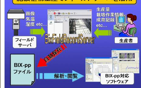
温室に設置したフィールドサーバなどからの情報を BIX-pp 形式で自動記録し、誰でも簡単に、自己の植物生産の BIX-pp ファイルを作成し、保存できます。
